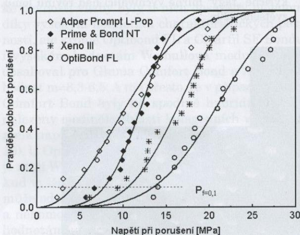
**Obr. 1.** Weibullův výnos pravděpodobnosti porušení adhezního spoje na působícím napětí pro několik typických adheziv.
