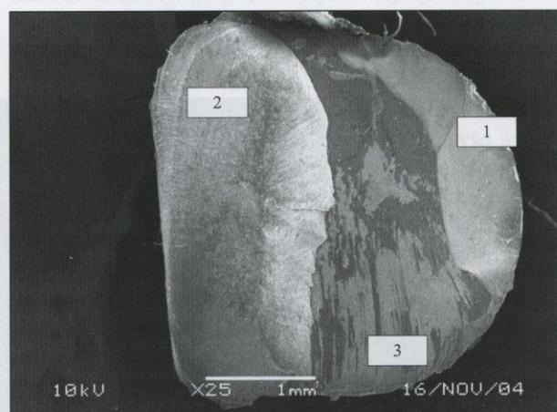
**Obr. 2.** Typický charakter smíšeného lomu zasahujícího do kompozitu (1), dentinu (2) a vrstvy adheziva či hybridní vrstvy (3). Pohled ze strany kompozitního materiálu, adhezivum Gluma Comfort Bond, zvětšeno 25x.
