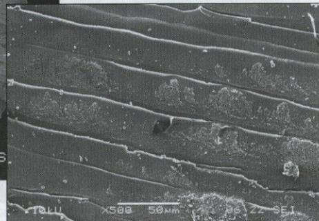
**Obr. 4.** Detail plasticky přetvořeného adheziva iBond se zbytky kompozitního materiálu na jeho povrchu, zvětšeno 500x.
