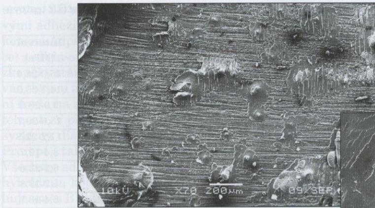
**Obr. 5.** Nepravidelné „ostrůvky“ kohezně porušeného adheziva Xeno III a typické puchýřky v adhezivu, zvětšeno 70x.
